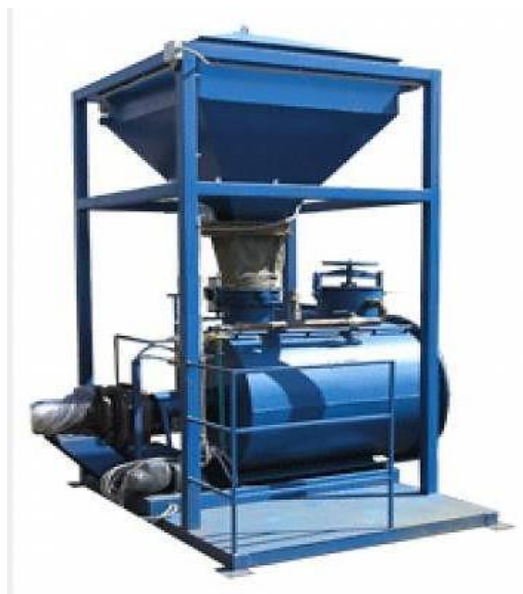
11 Сурет – Цемент пен құмға арналған автоматтандырылған мөлшерлеуіш кешен
